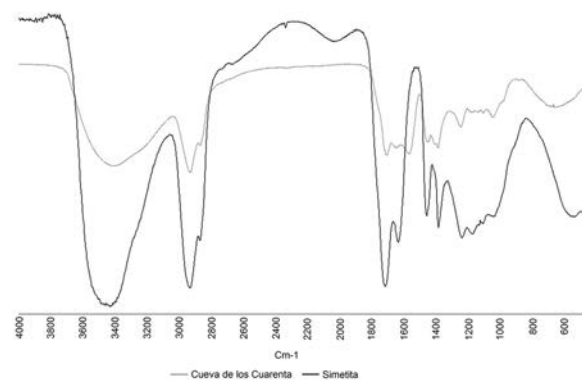
Fig. 5. Comparación del espectro de Infrarrojos por Transformada de Fourier de la muestra de ámbar de la Cueva de los Cuarenta (Priego de Córdoba, Córdoba) y del espectro característico de la simetita siciliana presentados en transmisión de infrarrojos.
